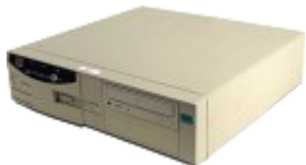
Gépház (fekvő típusú)
